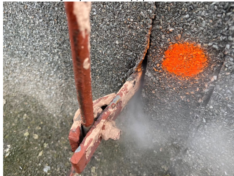
Obrázek 24: Projev dýmové zkoušky / příklad
