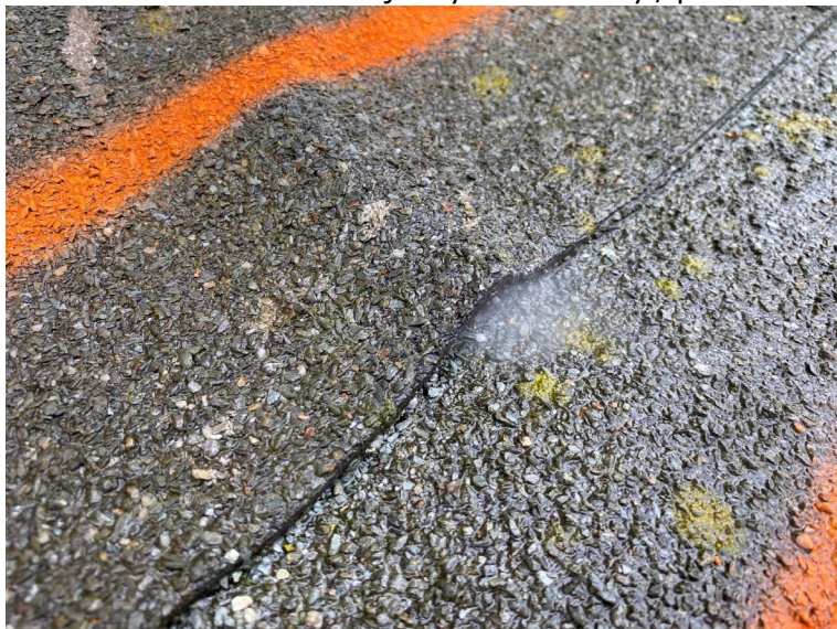
Obrázek 23: Projev dýmové zkoušky / příklad
