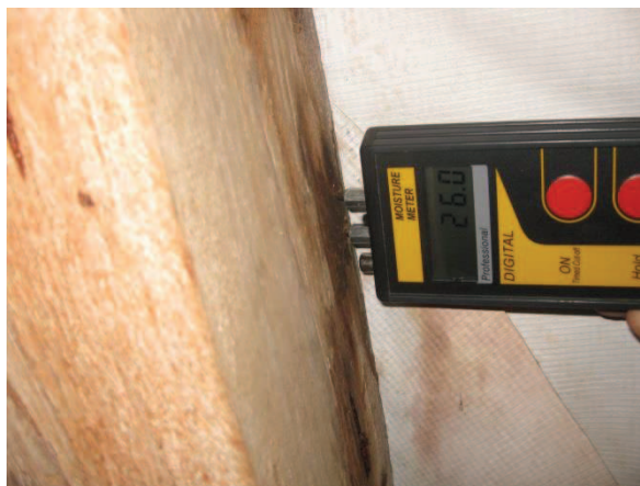
Obr. 44: Sonda S22 – měření vlhkosti krokví
