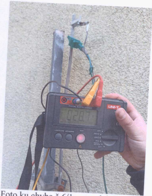
Foto ku chybe č.6/1 – vysoký zemný odpor na SZ1
