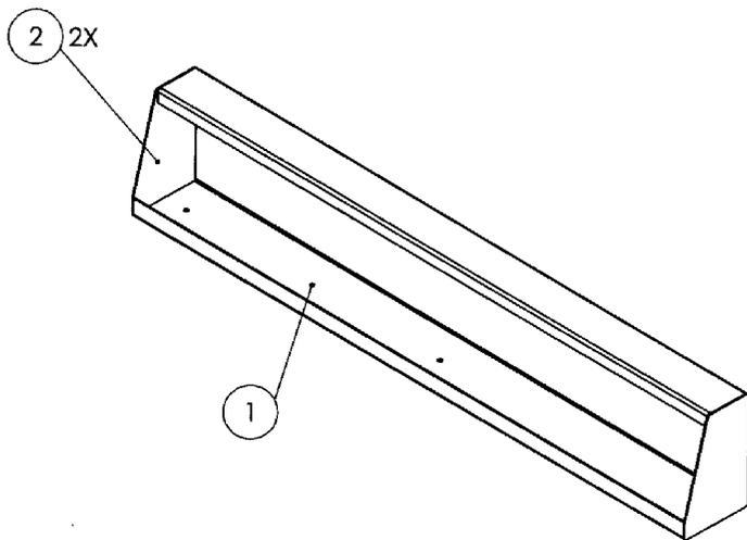
Stoßkanten verschweißt und verschliffen
