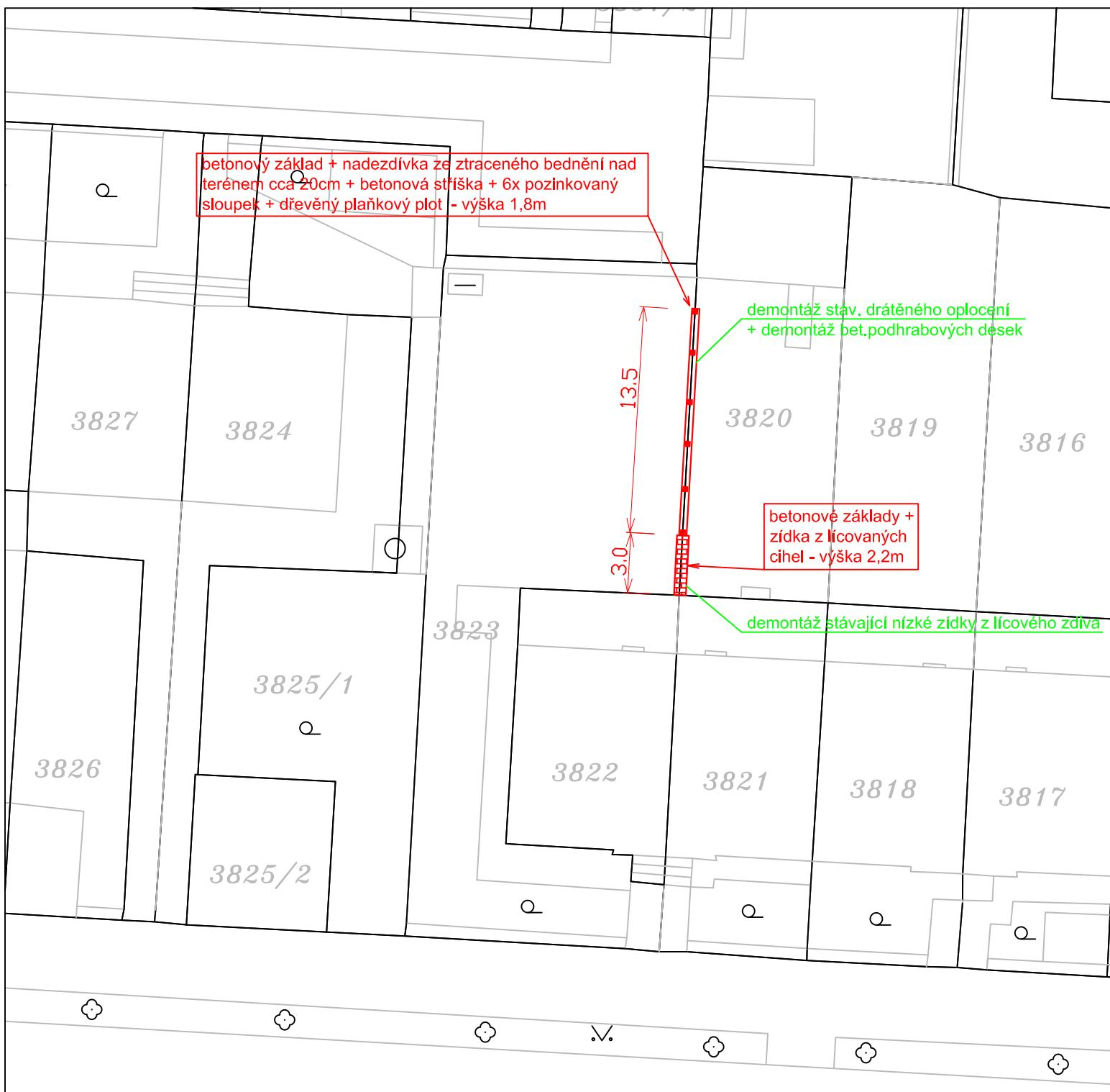
betonový základ + nadezdívka ze ztraceného bednění nad terénem cca 20cm + betonová stříška + 6x pozinkovaný sloupek + dřevěný plaňkový plot - výška 1,8m
