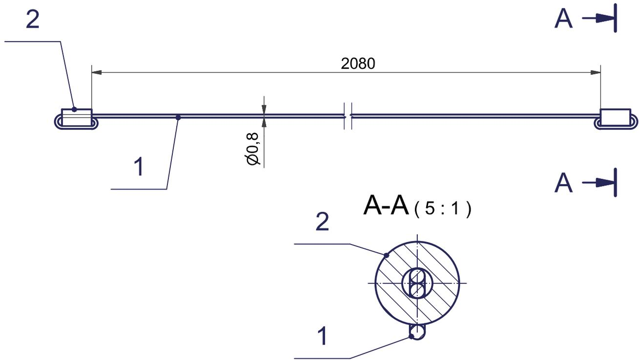
Pos. 2 Rundstahl  $\text{\O}4,5 \times 8$  ( 5 : 1 )
