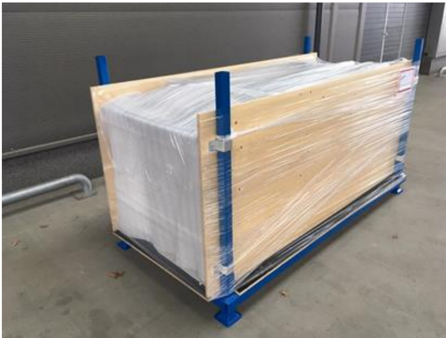
Kovový rám 2400 x 1200 x 1300 mm , maximální hmotnost 500 kg
