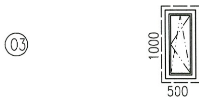
500 x 1000, 1 ks sklopné a otváracé jednokřídlové okno s izolačným trojsklom plastový rám, šesťkomorový, sivá farba RAL 7042 vnútorný parapet drevotrieska, 250 mm vonkajší parapet, plastový, 200 mm
