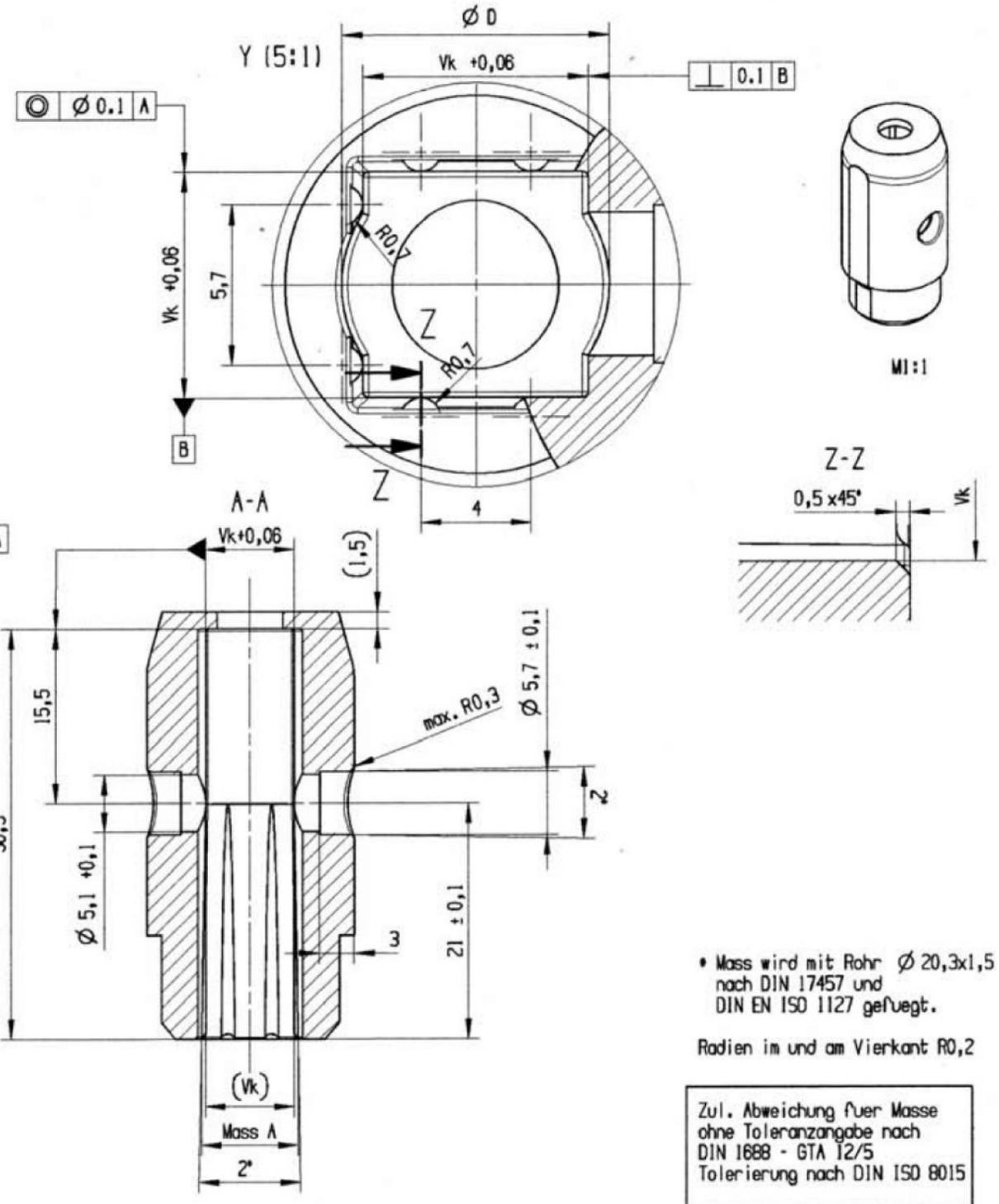
\* Mass wird mit Rohr  $\varnothing 20,3 \times 1,5$  nach DIN 17457 und DIN EN ISO 1127 gefuegt.
