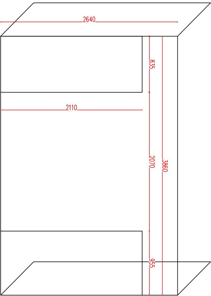
Stena medzi predsieneou a kuchyňou / obývačkou. Otvor v stene má výšku 211 cm, šírku 83,5 cm a 96 cm. Hrúbka steny vrátane omietky je 268 mm. Posuvné dvere na stenu by sme potrebovali tak, aby bolo možné dvere zachovať v uzavretom stave aj otvorenom stave. Stena je priebežná - napojená na oboch stranach na stenu kolmo s ňou. Ideálne bez zárubne, iba zasúvací mechanizmus a zasúv. dvere.
