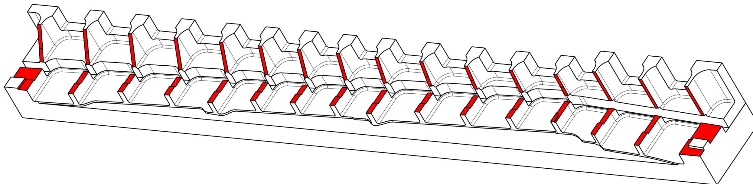
Usinage suivant modèle CAO. Assurer une localisation et une forme de l'ensemble des faces fonctionnelles entre elles (face rouge) à 0.08mm ( $\pm 0.04$ )
