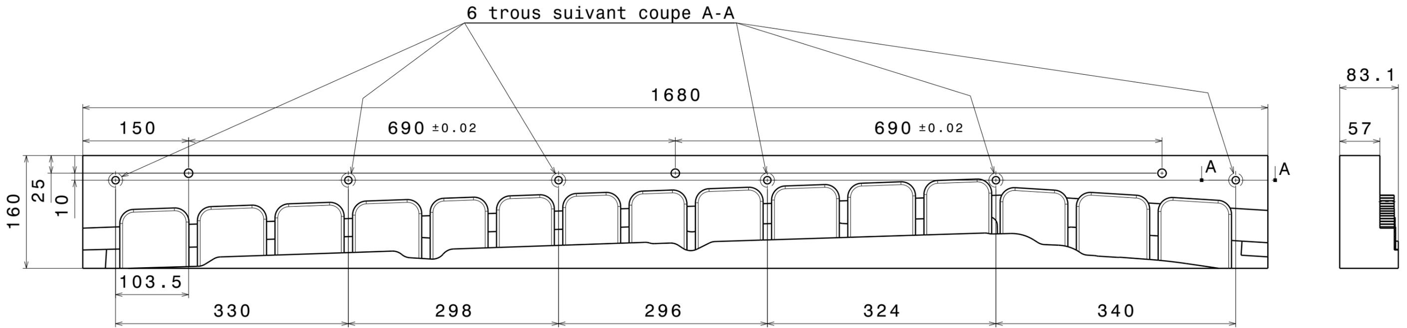
A réaliser avant assemblage suivant modèle CAO
